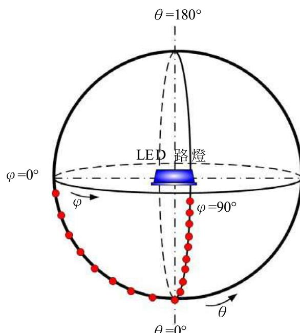
圖 B.3 LED 路燈以“測角色度計”系統進行色度特性量測之空間幾何架構
