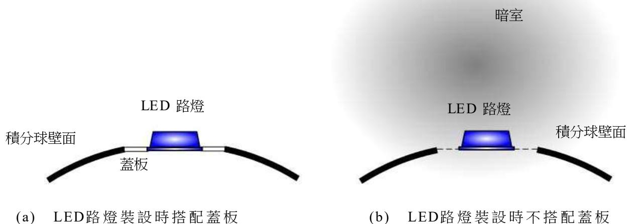
圖 B.2 受測 LED 路燈於積分球上之安裝條件
